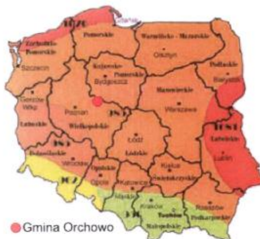
Ryc. 8. Średnioroczne sumy promieniowania słonecznego całkowitego padającego na jednostkę powierzchni poziomej w kWh/m²/rok Źródło: http://www.zielona-energia.cire.pl
